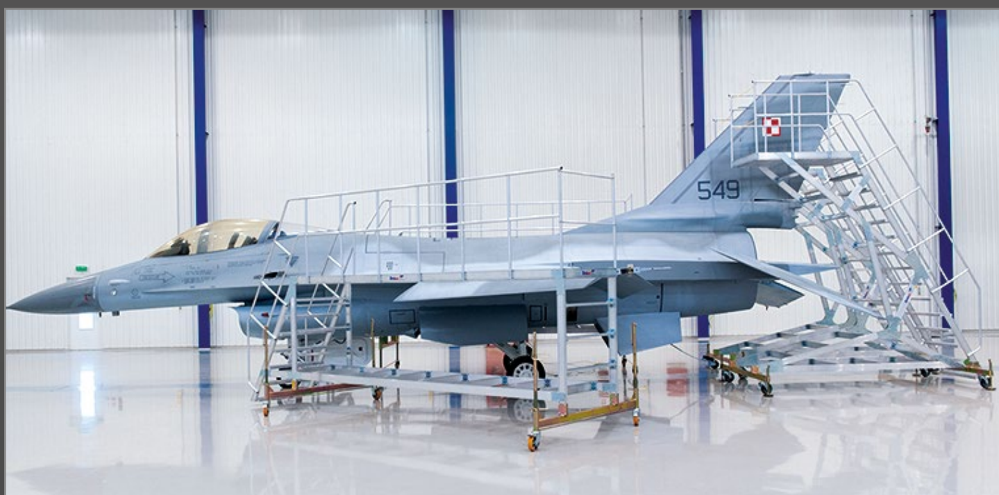
Specjalistyczne zestawy rusztowań jezdnych z platformami roboczymi
