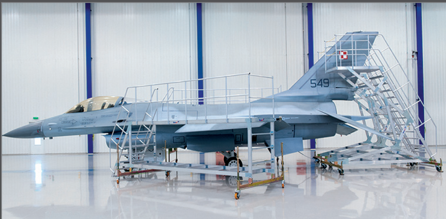
Specjalistyczne zestawy rusztowań jezdnych z platformami roboczymi
